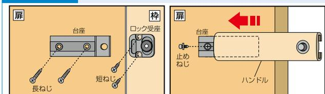
①ねじで台座とロック受座を取付けます。②ハンドルを台座に差し込み、止めねじを締めれば取付け完了です。
